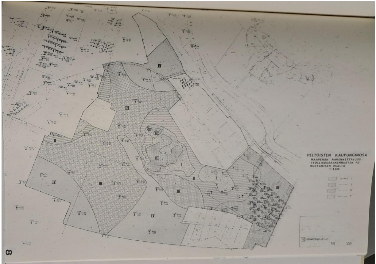
Kuva 27 – Kartta maaperän rakennettavuudesta teollisuusrakennusten perustamisen osalta
