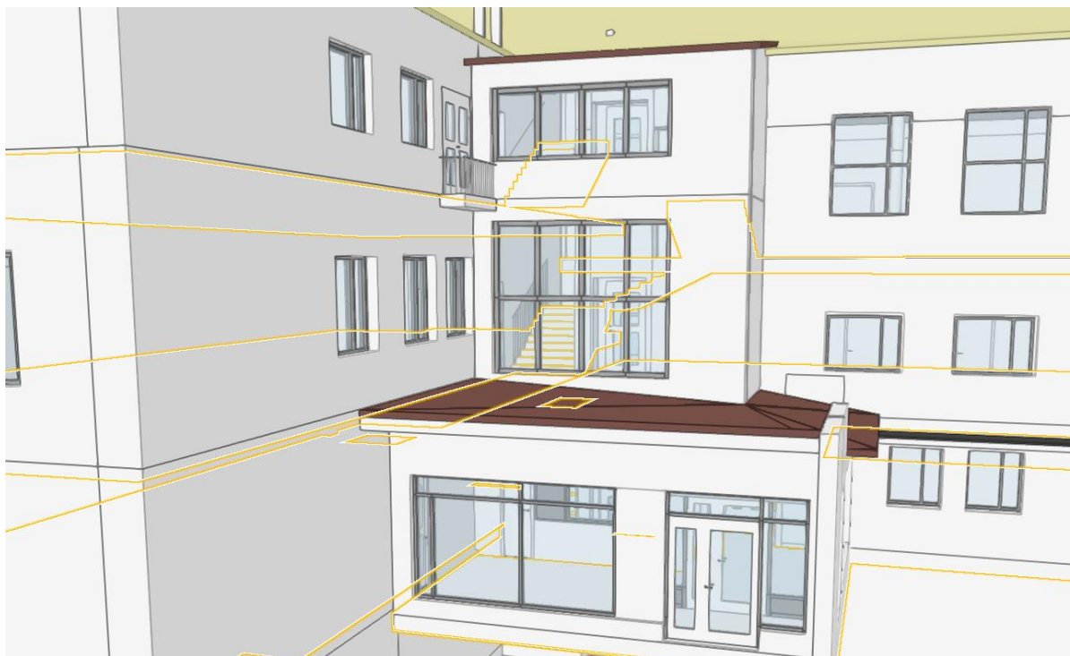
Kuva 2 - Ote rakennustietomallista, jossa korostettuna kerrokset 1-3 ja rappuset
